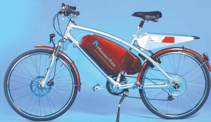
Als **Elektrofahrrad** ist dieser kleine Stadtcruiser mit Brennstoffzellenantrieb entwickelt worden. Der Prototyp gilt als Meilenstein für die Massenproduktion.
